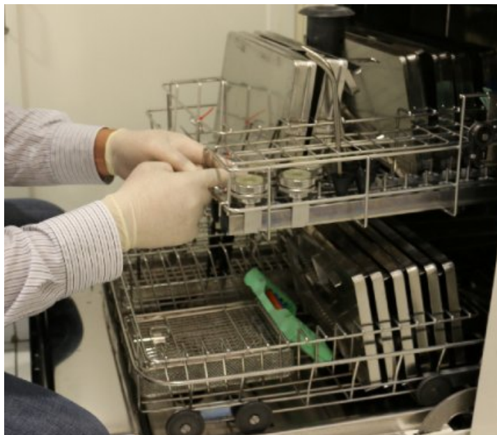
Dipl.-Ing. Thomas Schumann von der Firma ValiTech bringt Sensoren in der Beladung des zu validierenden Reinigungs- und Desinfektionsgerätes an.
