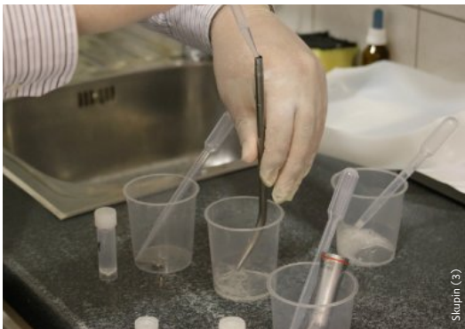
Fünf vorab bestimmte Instrumente werden auf ihren Restproteingehalt im Labor geprüft.
